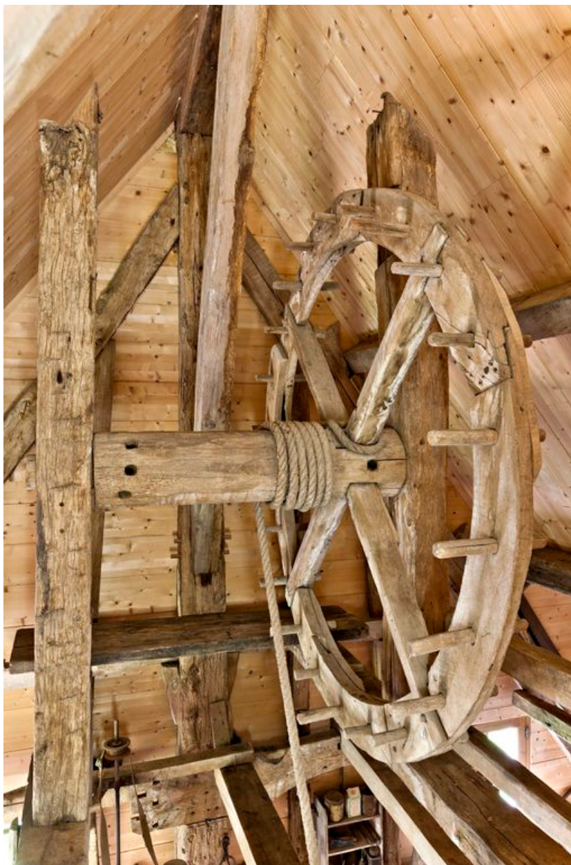
Détail du treuil à lever les meules
