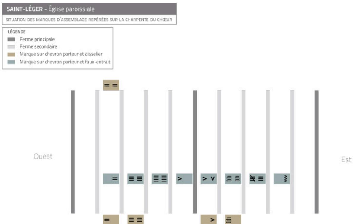
Chœur, charpente. Emplacement des marques d'assemblage repérées.
