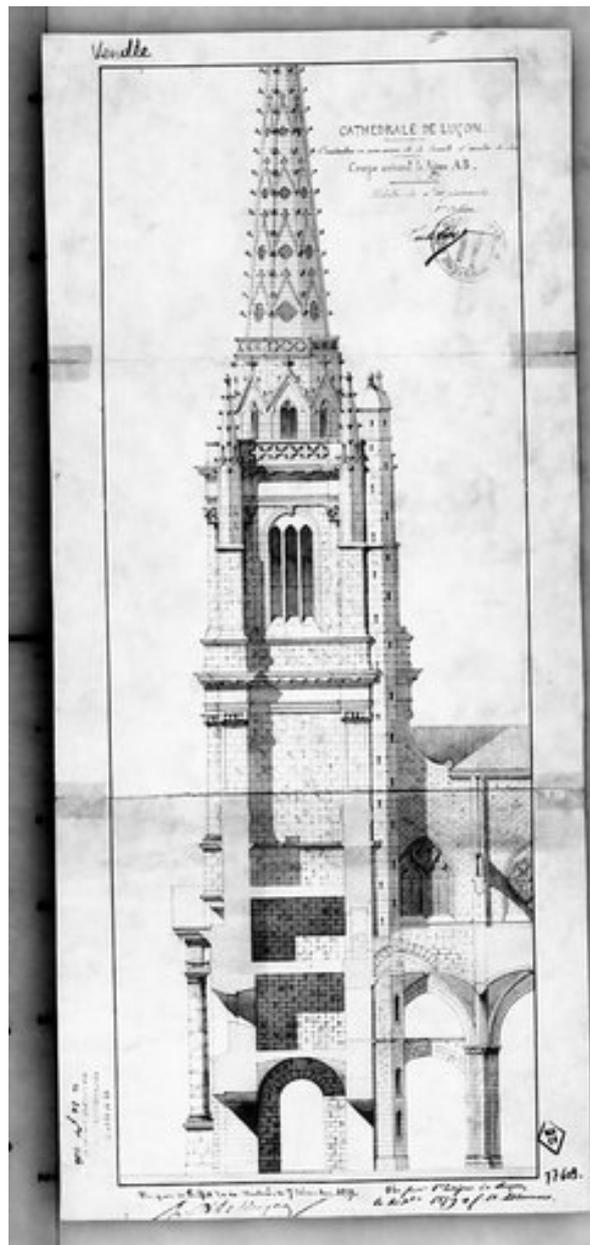
Construction en sous-œuvre de la tourelle d'escalier du clocher : coupe du massif occidental par Juste Lisch, architecte, en 1859.
