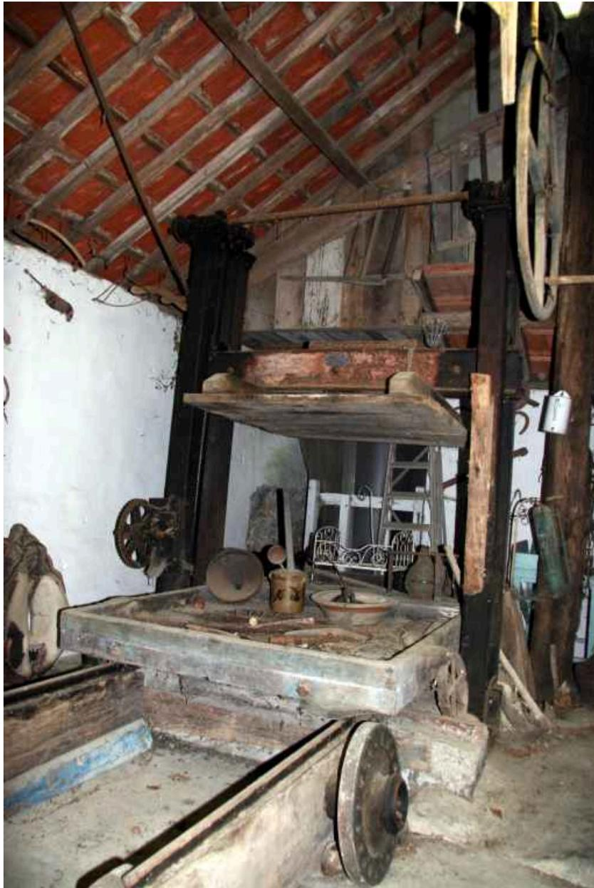
Pressoir sur rails qui permet le rechargement d'un deuxième plateau.
