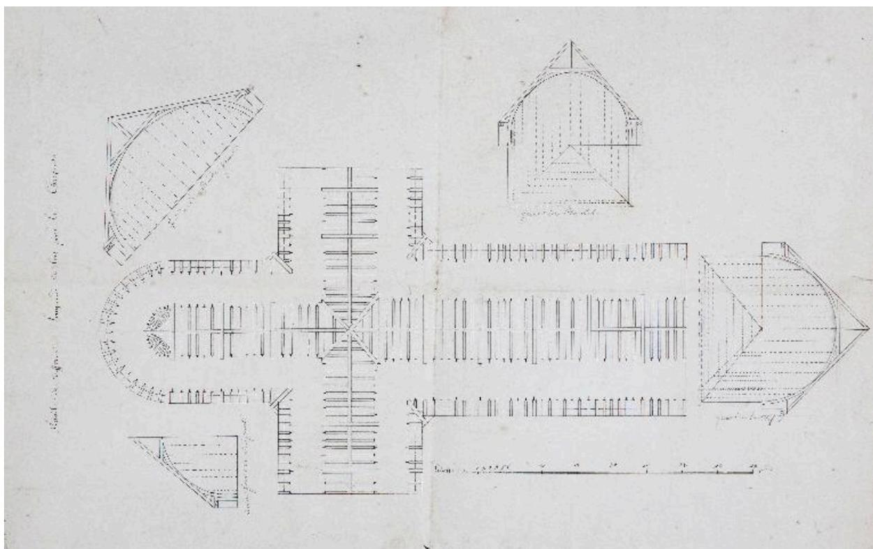
Projet de reconstruction (non réalisé) : plan de la charpente et élévations des fermes des différentes parties de l'église.
