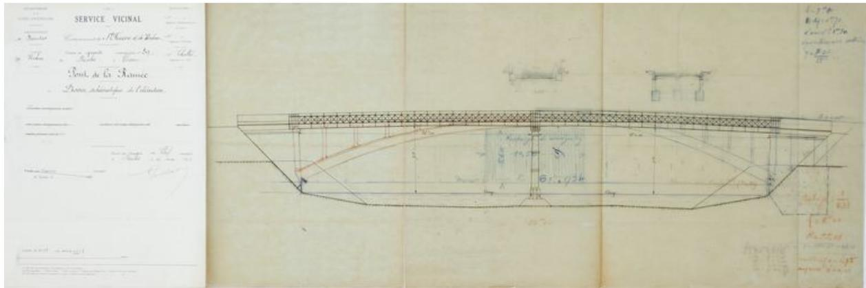
Projet de reconstruction du pont de la Ramée : superposition des deux ouvrages par l'ingénieur Choblet, mai 1933.
