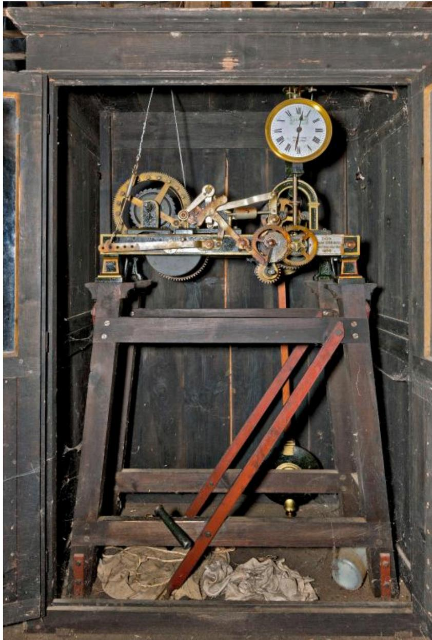
Comble : mécanismes de l'horloge mécanique.
