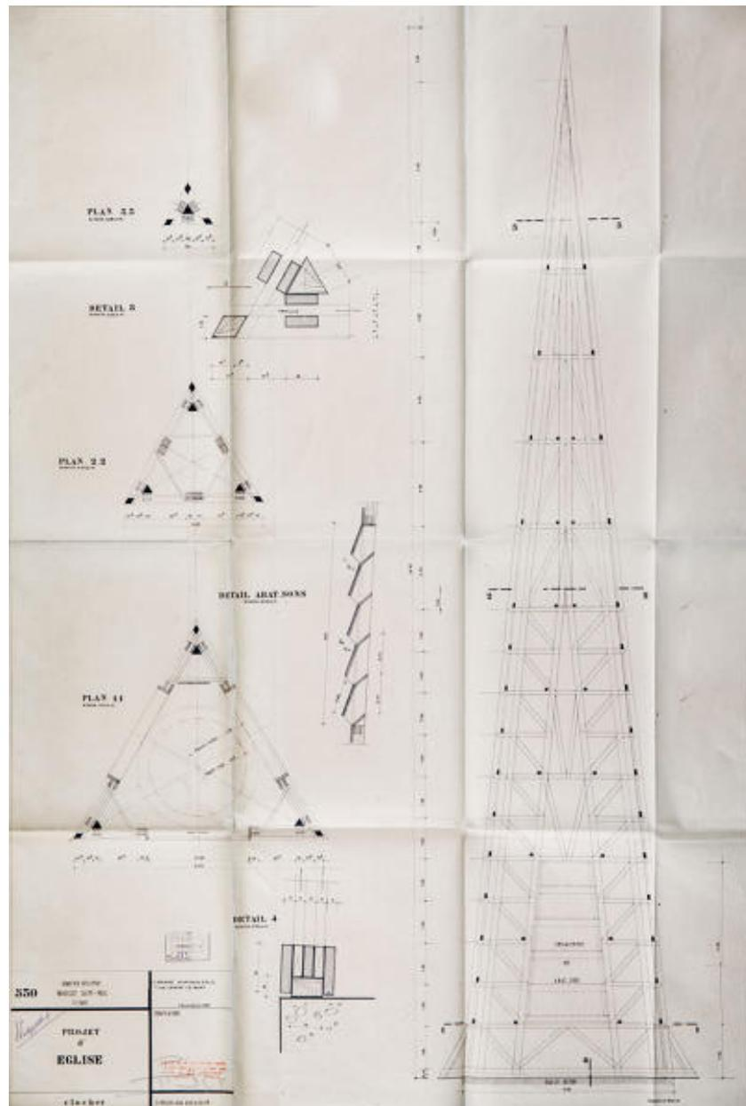
Coupe pour la charpente de l'église et élévation pour la toiture du clocher, 1963.
