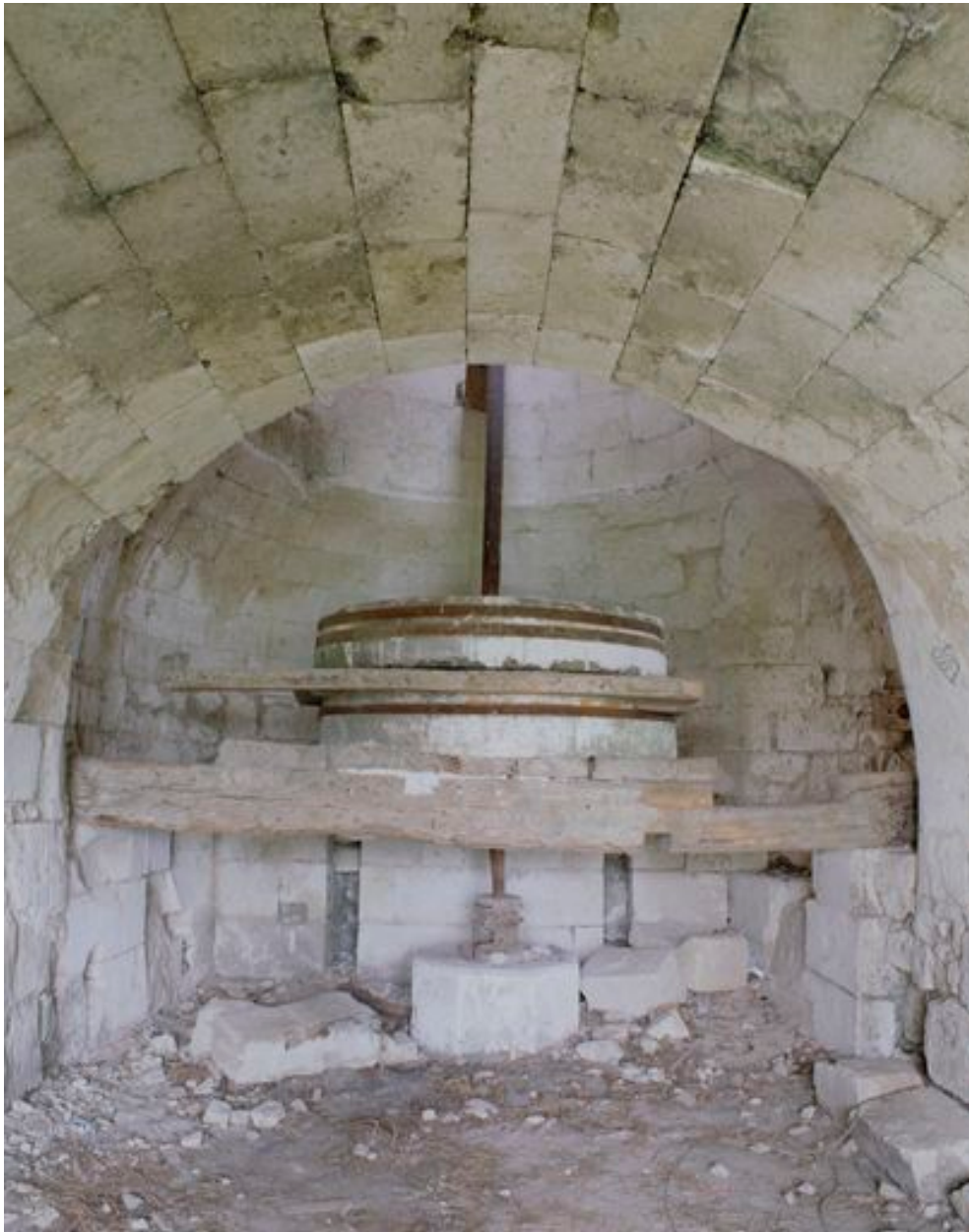
Le mécanisme du moulin, meules et gros fer (en 1991).
