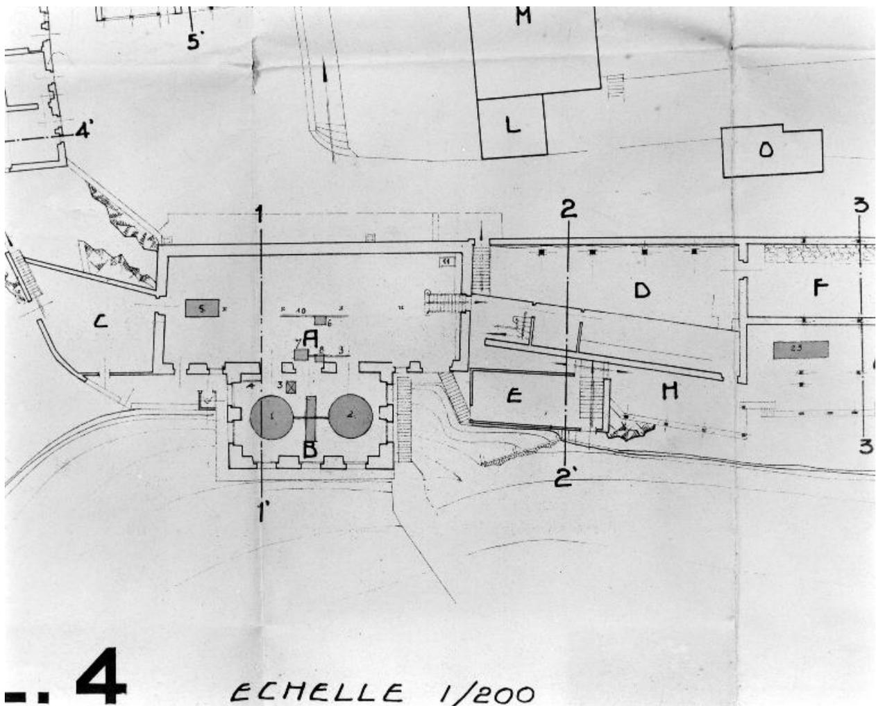
Extrait du plan de l'usine néo-métallurgique et de ses dépendances : détail figurant le bâtiment abritant les turbines et les salles utilisées pour la fabrication des métaux.
