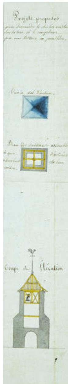
Plan et coupes du clocher de l'église montrant le projet de remplacer la flèche par une toiture en pavillon, 1816.
