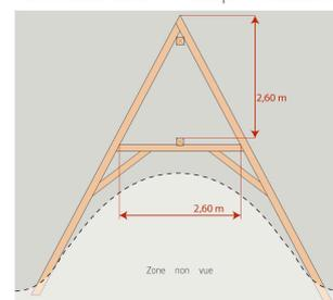
Relève schématique de la charpente du logis : vue générale du corps principal et de la tour nord, coupe longitudinale et coupes transversales sur une ferme principale et sur une ferme secondaire du corps principal.
