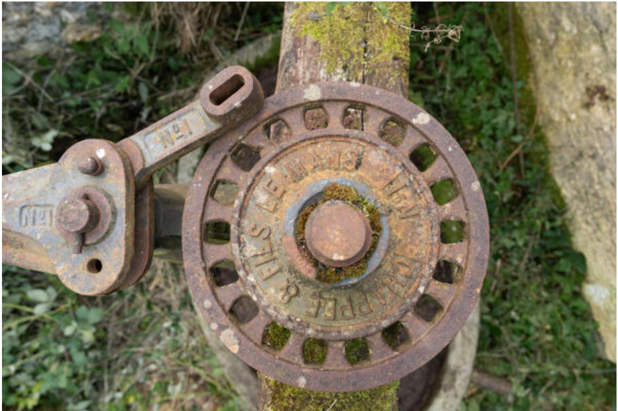
Pressoir à fruits : vis avec marque de fabricant et numéro de série.
