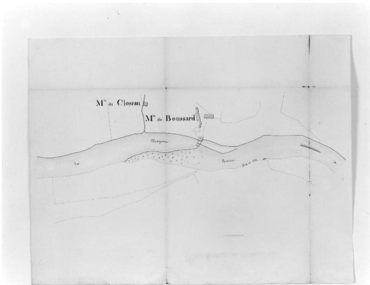
Plan d'ensemble du site avant la construction de l'écluse : chaussée, moulin et ses dépendances.
