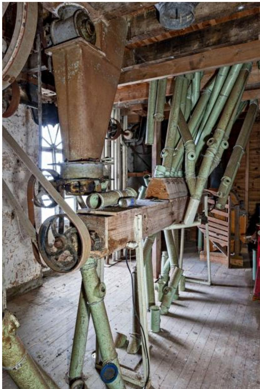
Deuxième étage, partie nord vue depuis l'ouest : l'ensacheur récupérant la farine venant du filtre à air situé au-dessus et les conduites pneumatiques reliant les broyeurs au plansichter.
