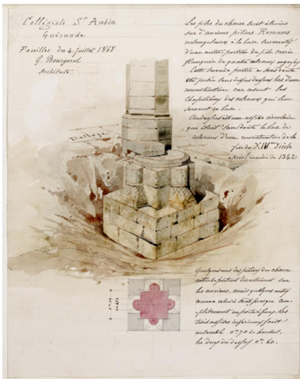
Base de colonne avec élément lapidaire en remploi. Dessin de l'architecte Gustave Bourgerel lors des fouilles du 4 juillet 1868.
