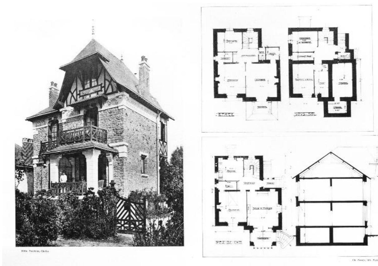
Vue de la villa Les Clochette et plans du sous-sol, du rez-de-chaussée, du 1er étage et coupe nord-sud, vers 1911.
