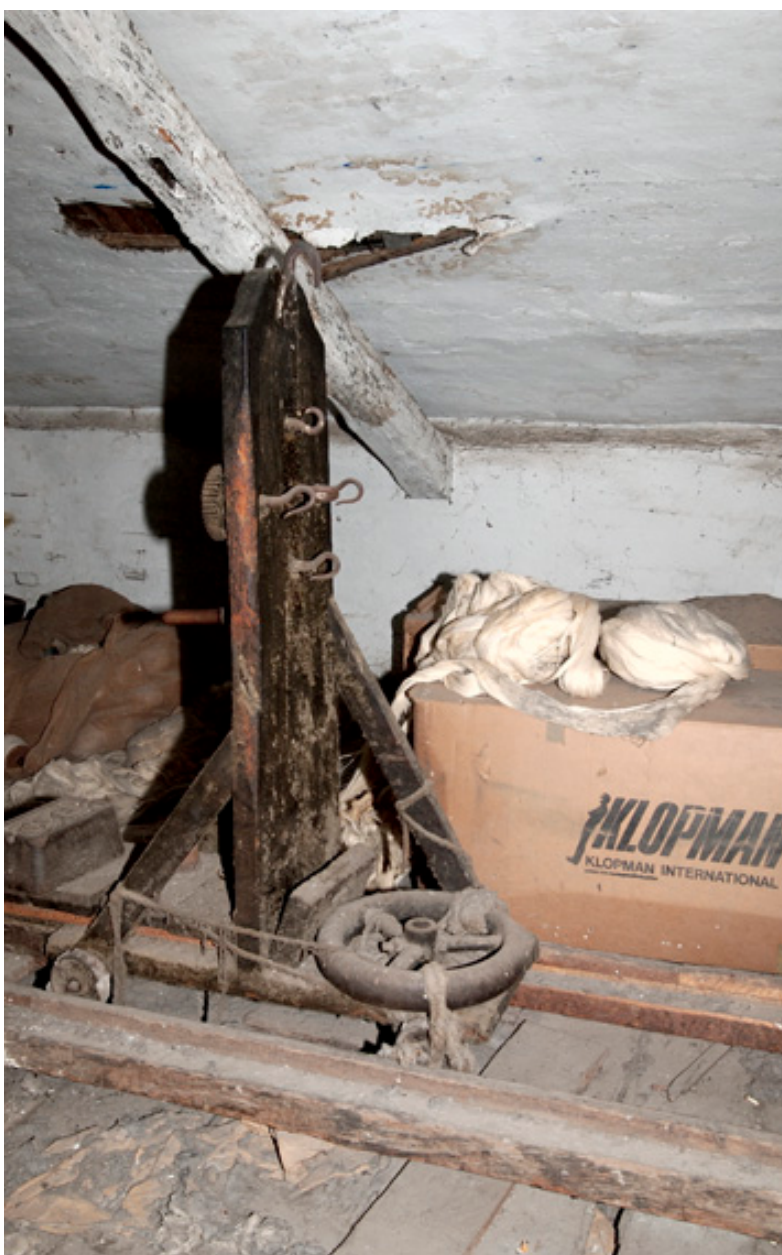
Niveau de comble de la filature, avec chariot pour tordre les fils.
