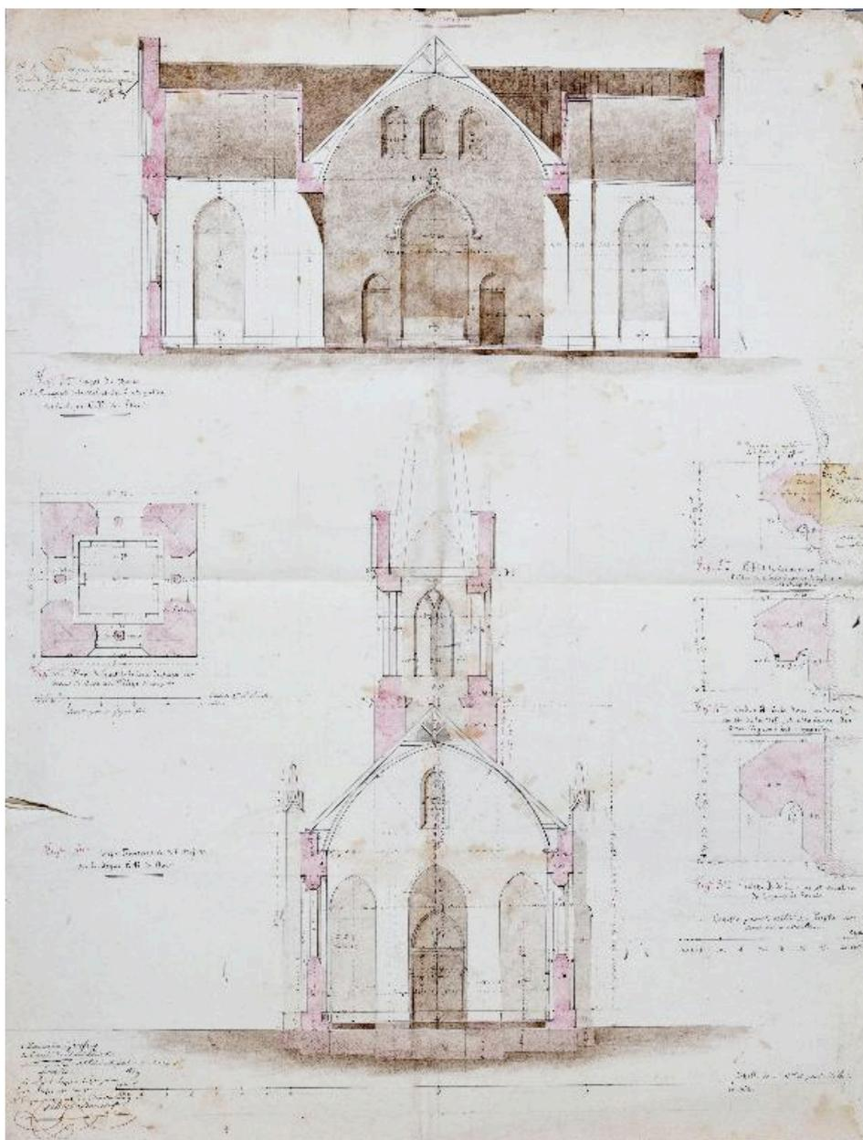
Projet de reconstruction (réalisé) : coupe transversale de la nef, coupe de l'extrémité de la nef et des deux chapelles, profil des corniches du clocher-porche et de l'intérieur de l'église, plan du clocher à la base de la flèche.
