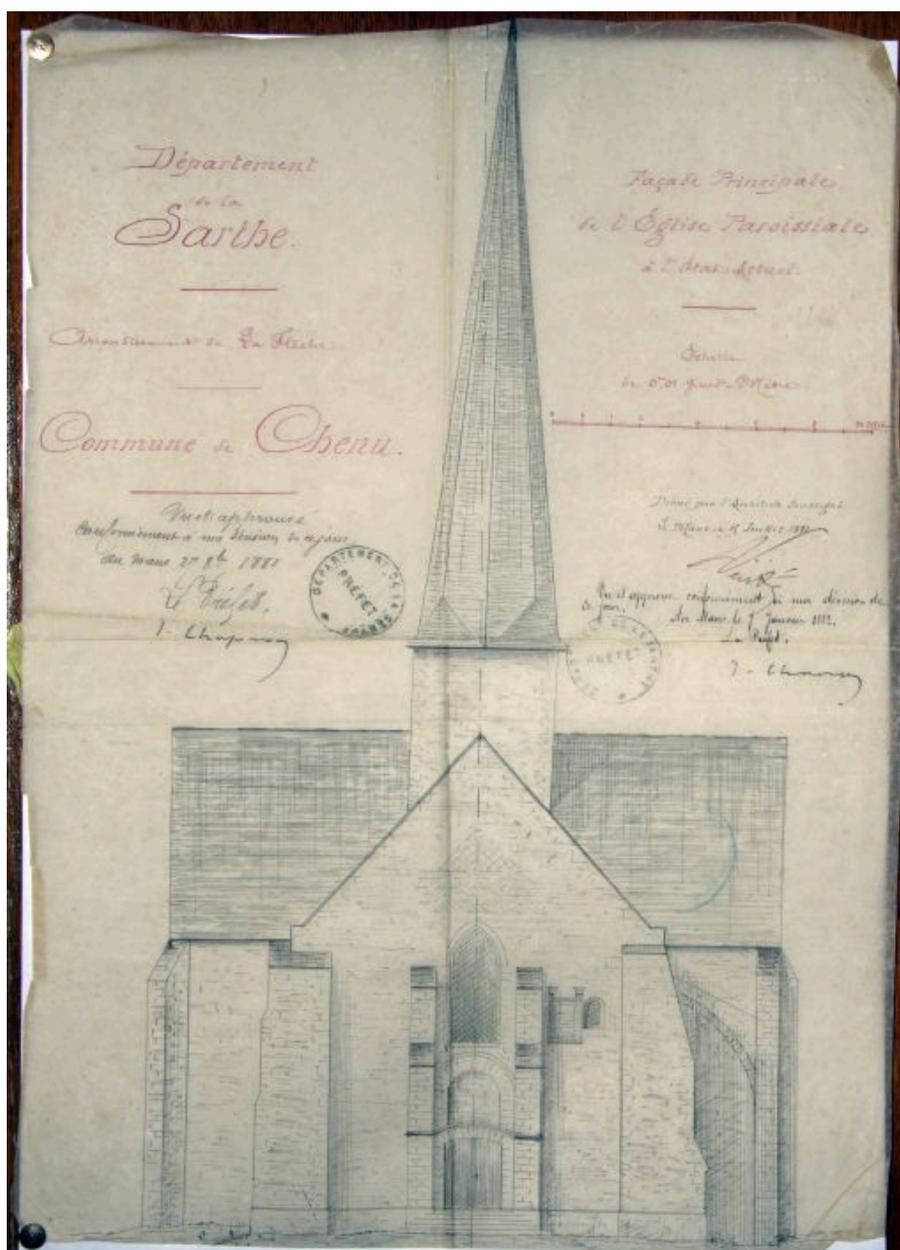
Élévation géométrale de la façade principale, 1881 : profil de l'ancien clocher et façade avant restauration.
