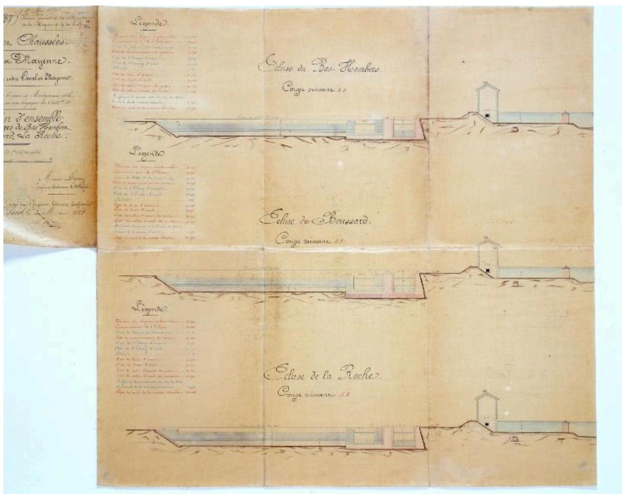
Projet de canalisation de la Mayenne entre Bas-Hambert et la Roche. Coupes longitudinales des barrages de Bas-Hambert, Boussard et la Roche.
