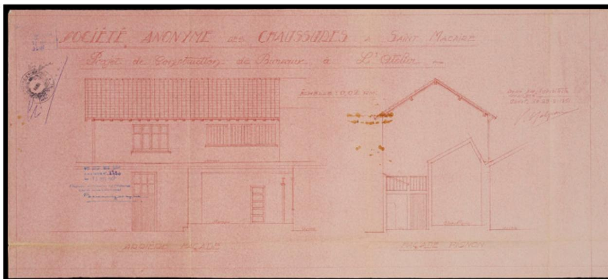
Elévations pour la construction de bureaux au 13 rue Jeanne d'Arc, par l'architecte Victor Rabjeau, pour la SAC, en 1951
