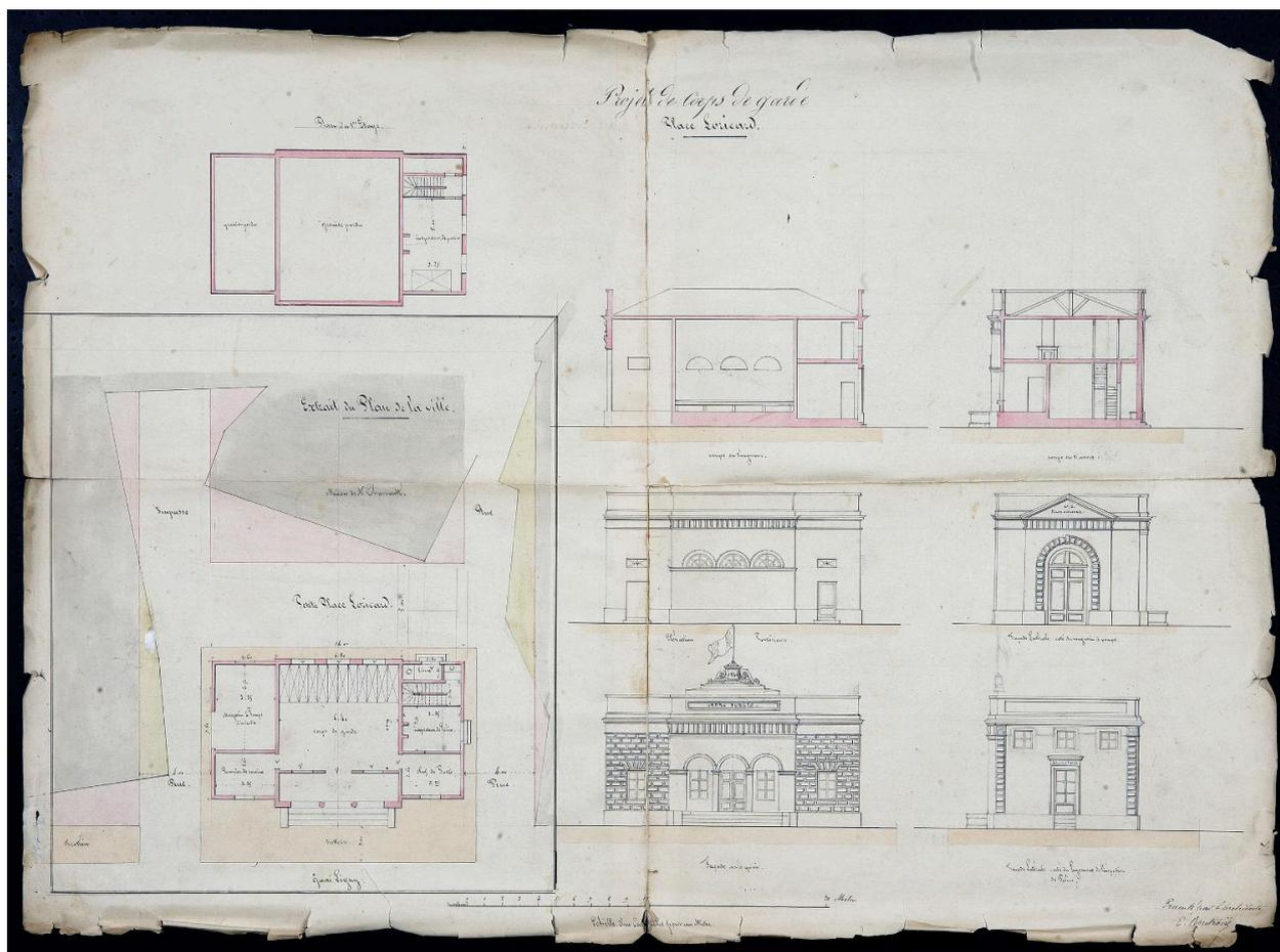
Projet de corps de garde. Place Loricard [5 quai Ligny], en remplacement de celui du quai Royal : plans du rez-de-chaussée et de l'étage, coupes longitudinale et transversale, élévations des quatre faces (projet non réalisé), par E. Boutrouë, [1846].
