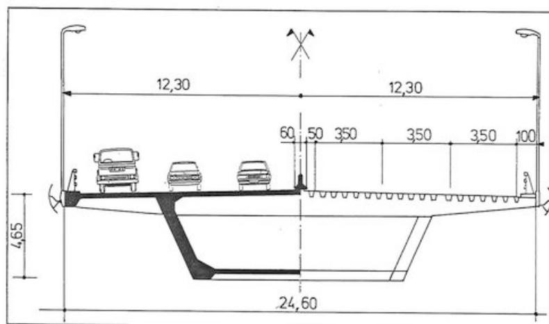
Développé d'une culée à l'autre et schéma de coupe du tablier du pont de Cheviré.
