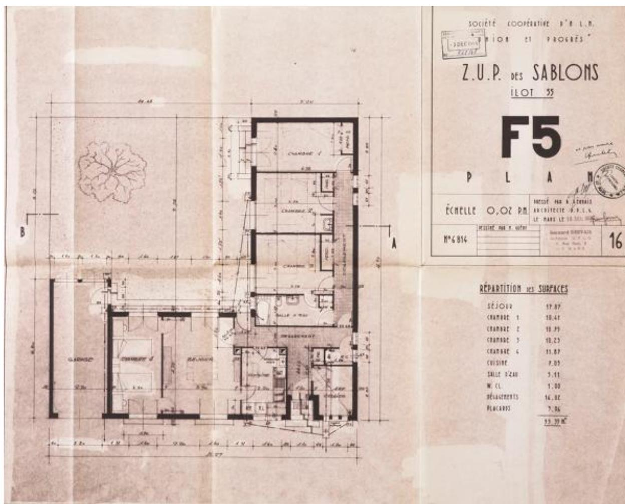
Plan type d'un pavillon F5 en vue de la construction de 11 pavillons au lot n° 55, 1968.
