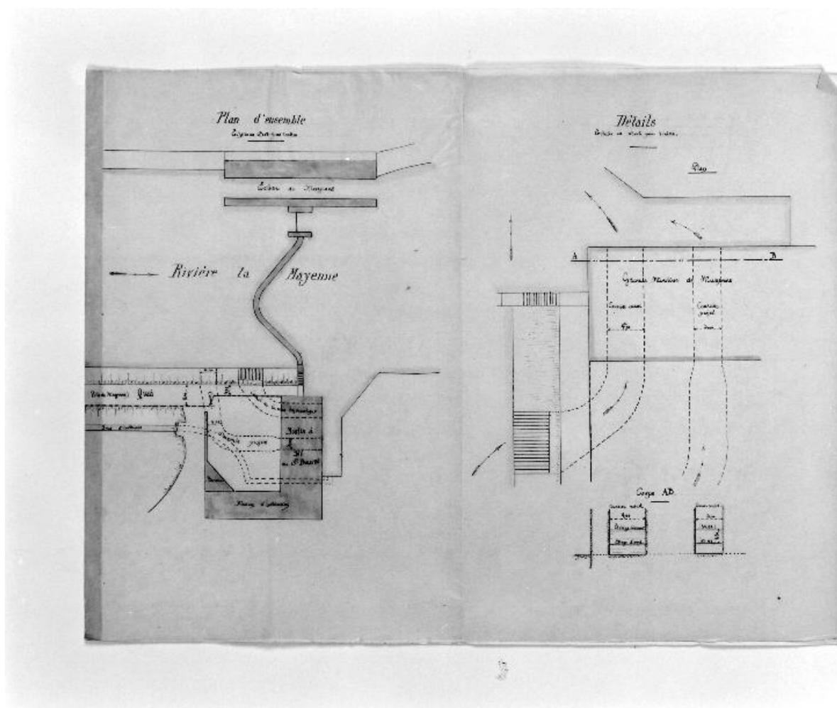
Plan d'ensemble du site d'écluse et du moulin ; plan de détail et coupe des coursiers .
