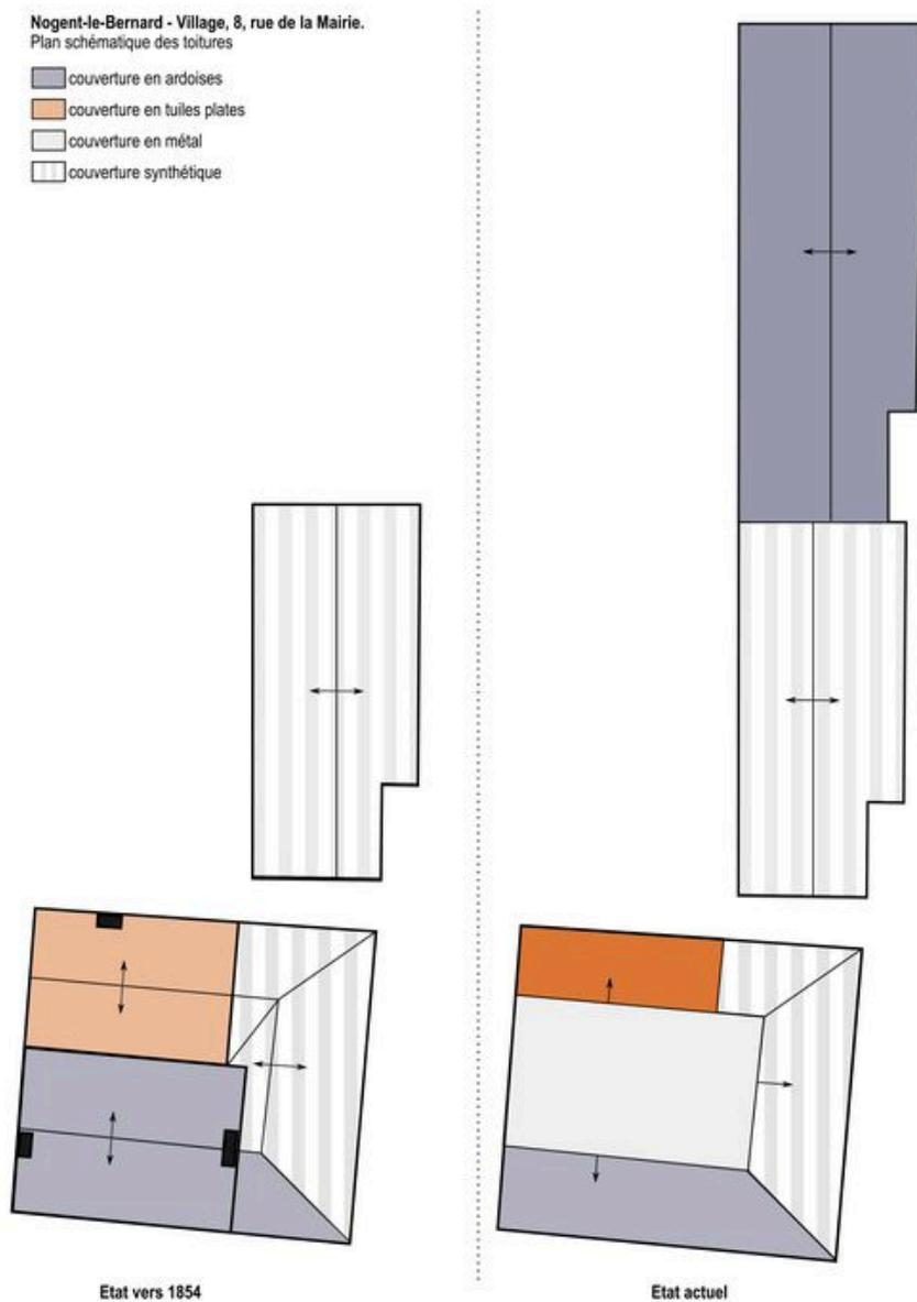
Plan schématique des toitures.
