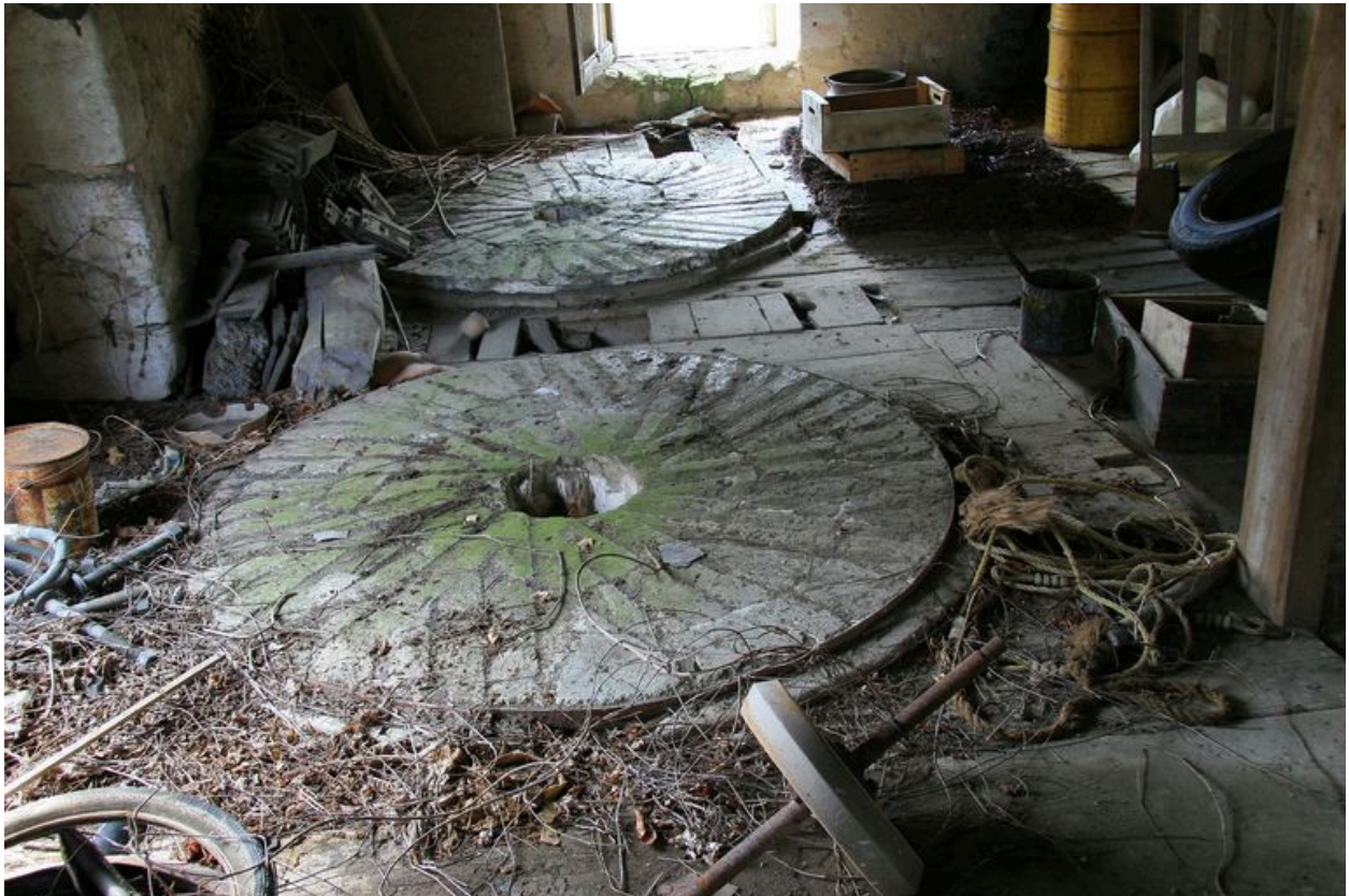
Le moulin : chambre des meules à sillons rectilignes.
