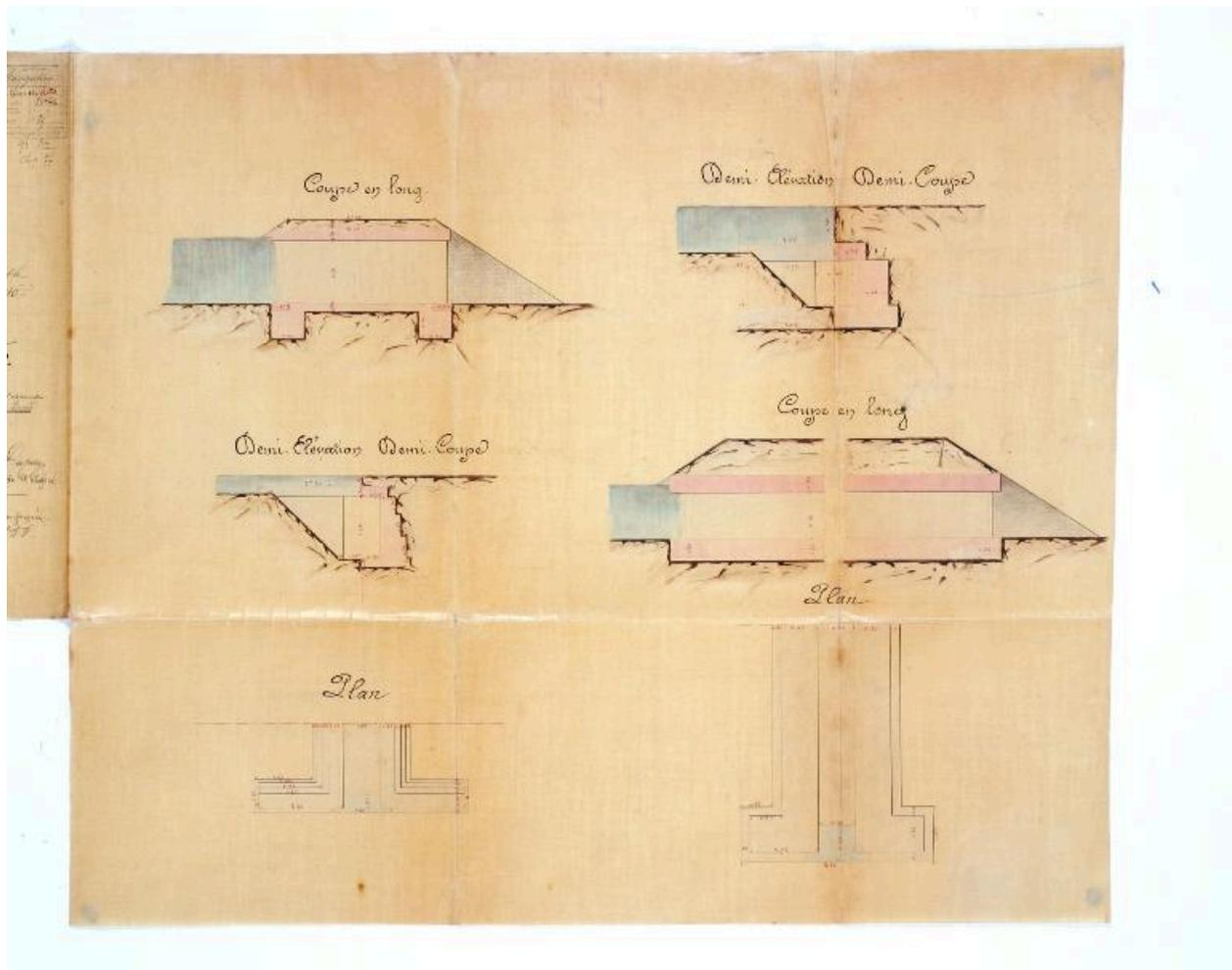
Projet de canalisation de la Mayenne de Montgiroux à Grenoux. Dessin type d'un aqueduc de 1 mètre et de 0,40 mètre d'ouverture.
