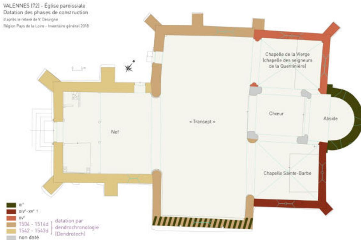
Le relevé avec la datation des phases de construction.
