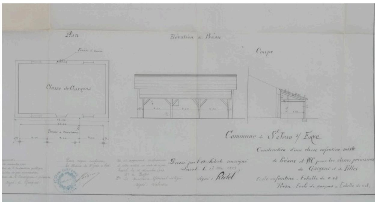
Construction d'une classe mixte, de water-closets et de préaux pour l'école primaire ; plans, élévations et coupes de la classe et du préau. Détail : élévation et coupe du préau.
