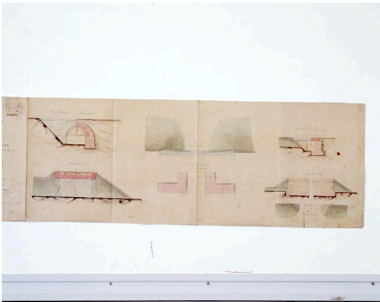
Projet de canalisation de la Mayenne de la Verrerie aux Communes. Dessin type d'un ponceau de 2 mètres d'ouverture et d'un aqueduc de 0,40 mètre.
