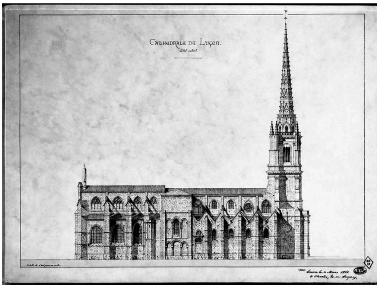
Etat avant restauration de la façade nord : élévation au 1/200e par Juste Lisch, architecte, en 1861.
