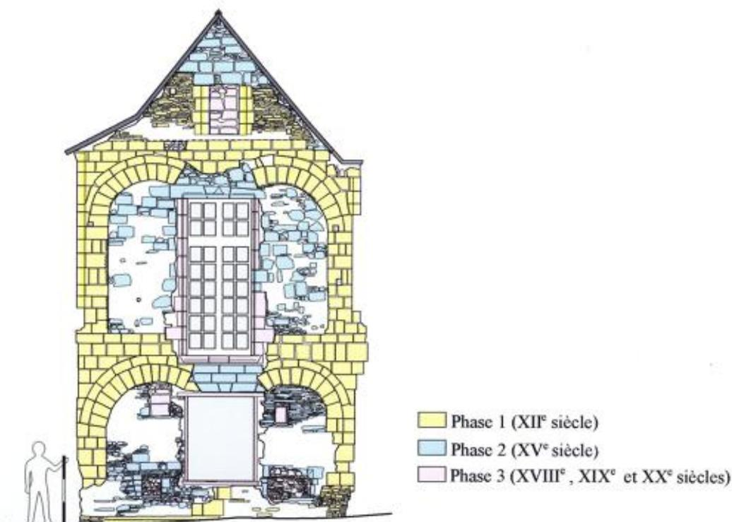
Logis XIIe siècle : élévation sur rue avec phasage des maçonneries, relevé, par J. Mastrolorenzo, 2002, éch. 1:100e.
