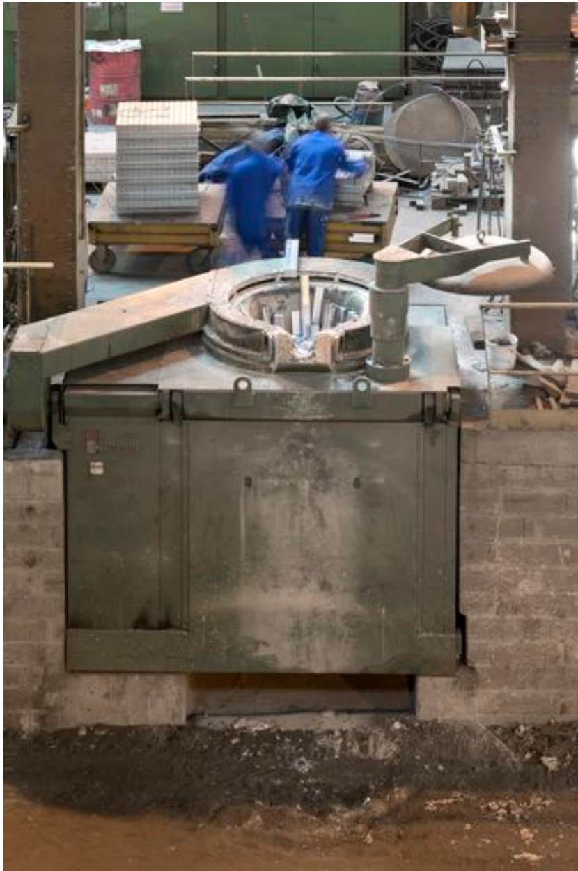
Remplissage du four de lingots d'aluminium pour la fonte.
