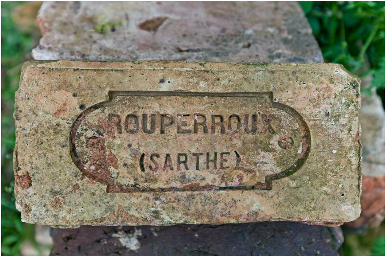
Exemple de brique de 220 x 60 x 105 mm environ.
