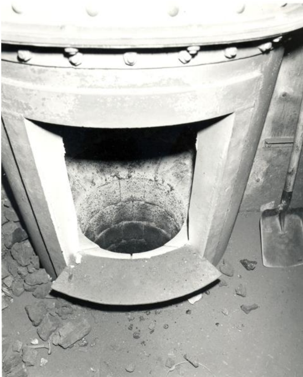
Atelier de fonderie : cubilot gauche, orifice d'enfournement.
