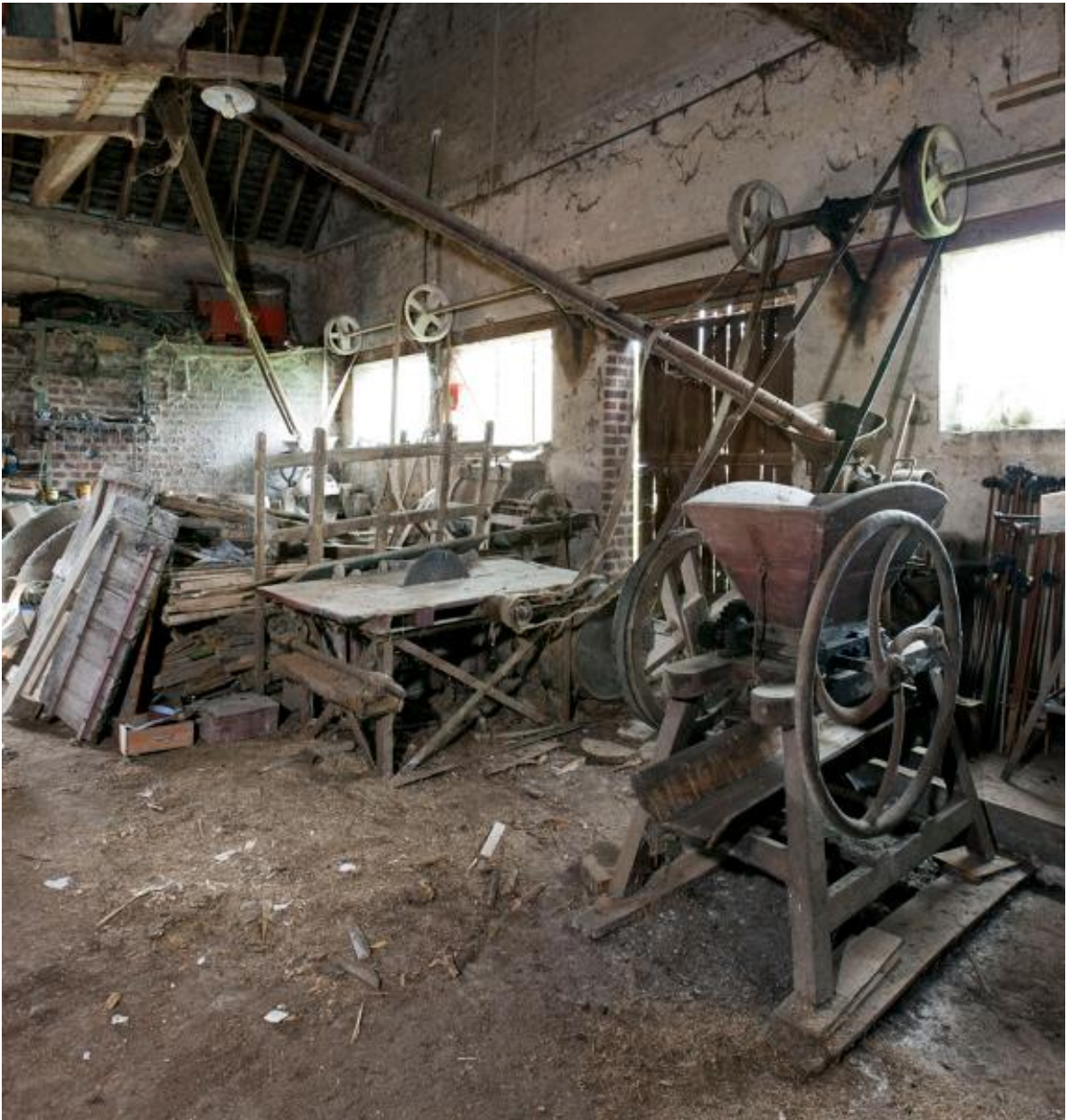
Laiterie 1, au mur : détail du banc de scie à double transmission électrique.
