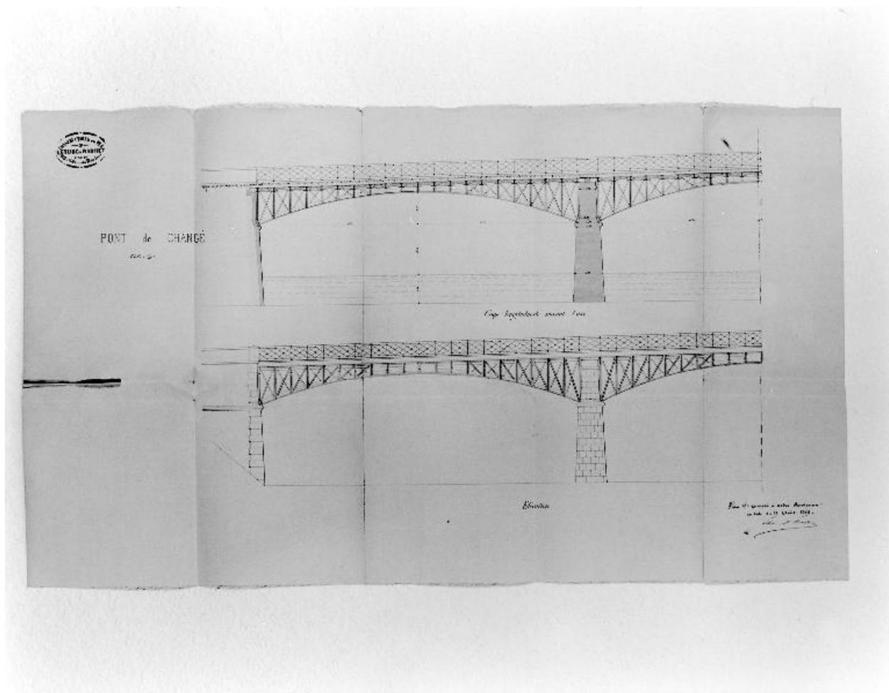
Projet de tablier métallique (non réalisé). Coupe longitudinale et élévation.
