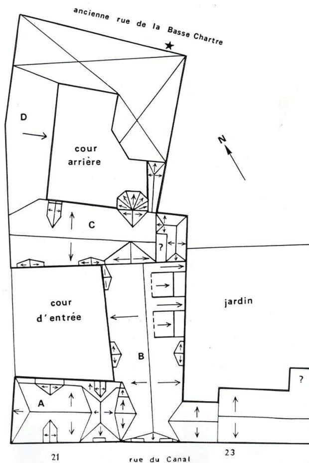
Plan schématique des couvertures.
