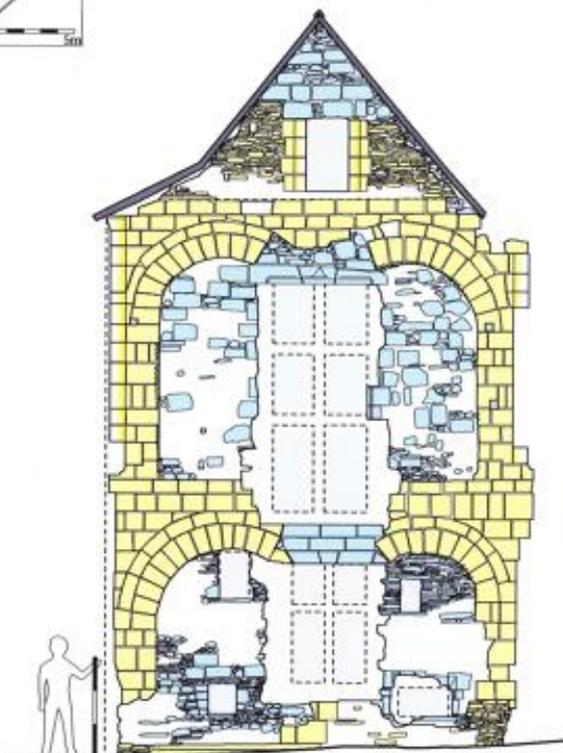
Logis XIIe siècle : élévation sur rue avec phasage des maçonneries et restitution des ouvertures XVe siècle, relevé, par J. Mastrolorenzo, 2002, éch. 1:100e.
