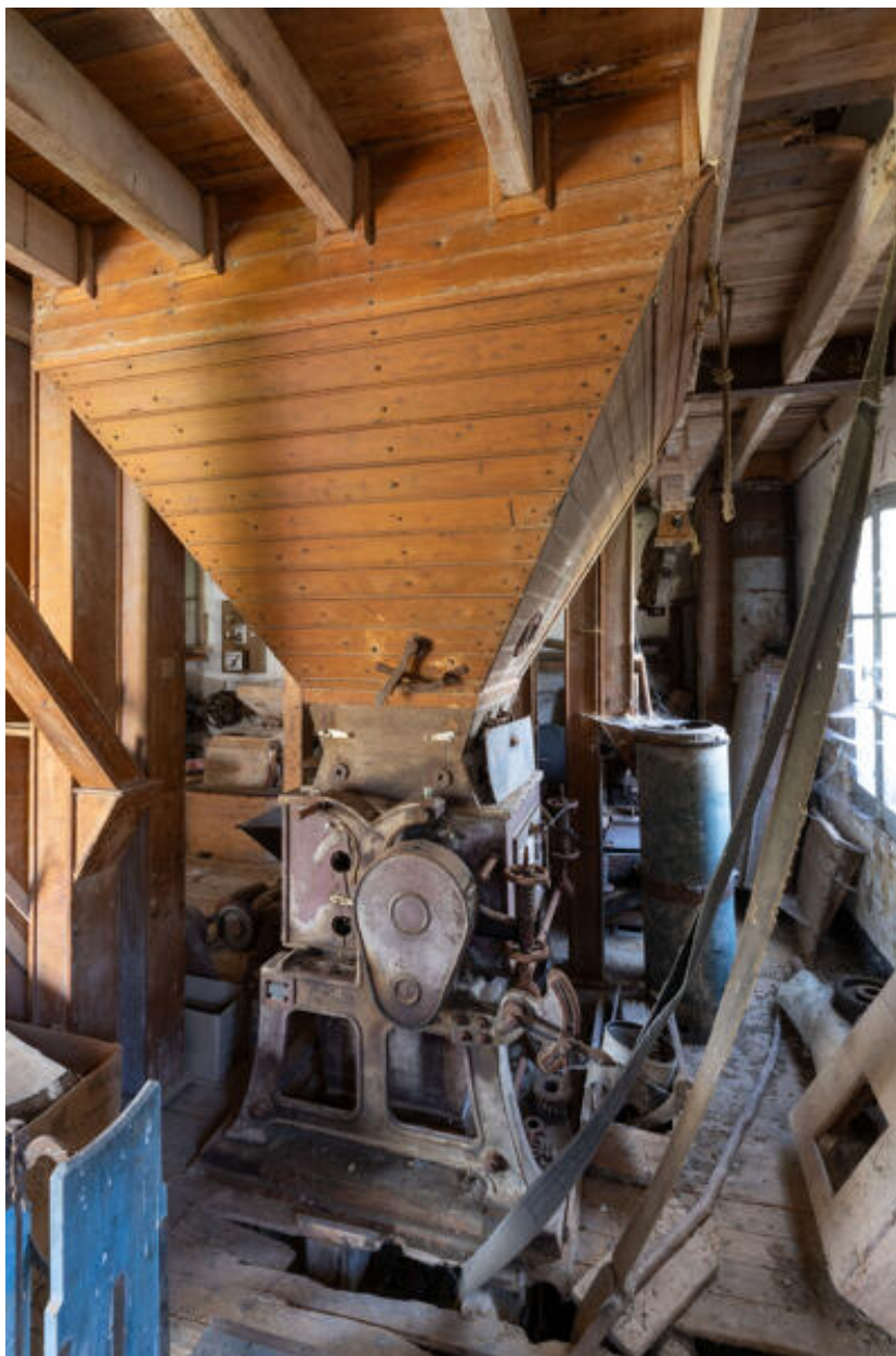
Machines du moulin, premier étage : broyeur.
