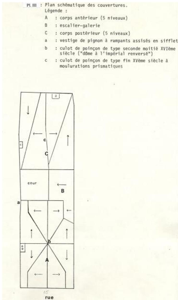
Plan schématique des couvertures.
