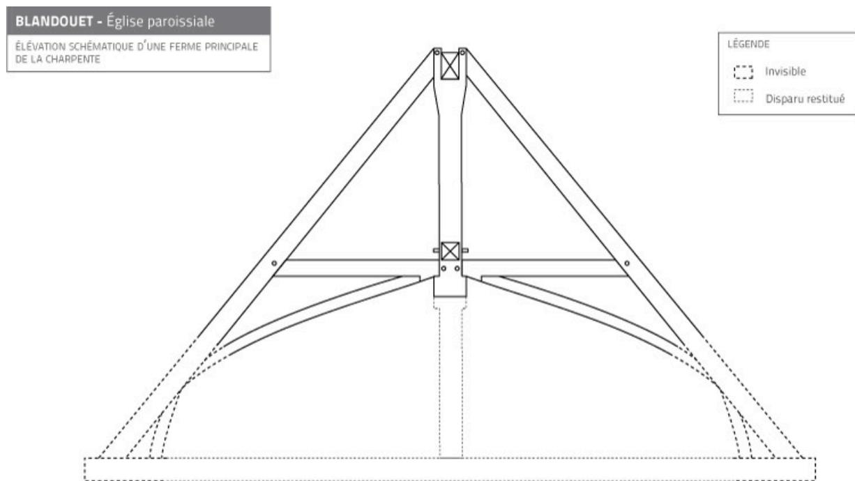
Elévation schématique d'une ferme principale de la charpente.
