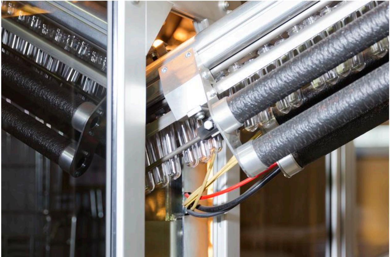
20 boulevard de Cardiff : Ligne plastique, tube avant la mise en forme en bouteille.
