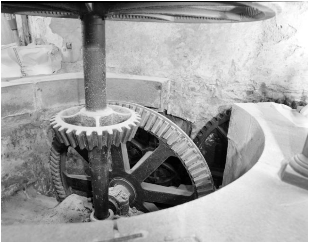
Détail du système de transmission commandé par la roue du large.
