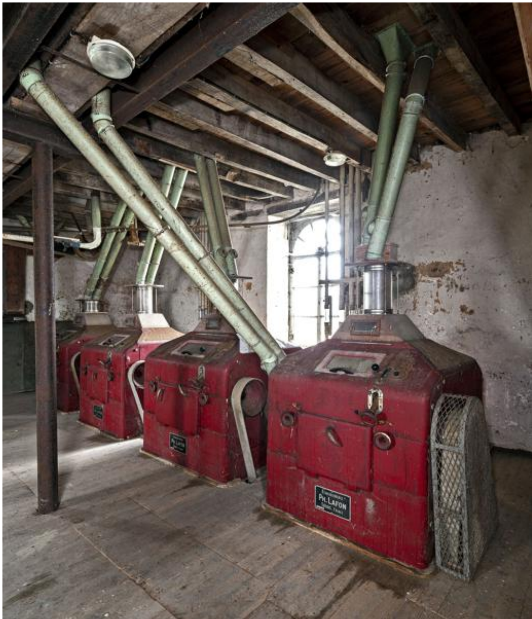
Premier étage, partie nord vue depuis le sud-est : les broyeurs à cylindres.
