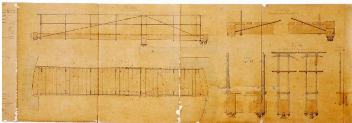
Projet d'écluse des Communes : plan, élévation et coupes de la passerelle.
