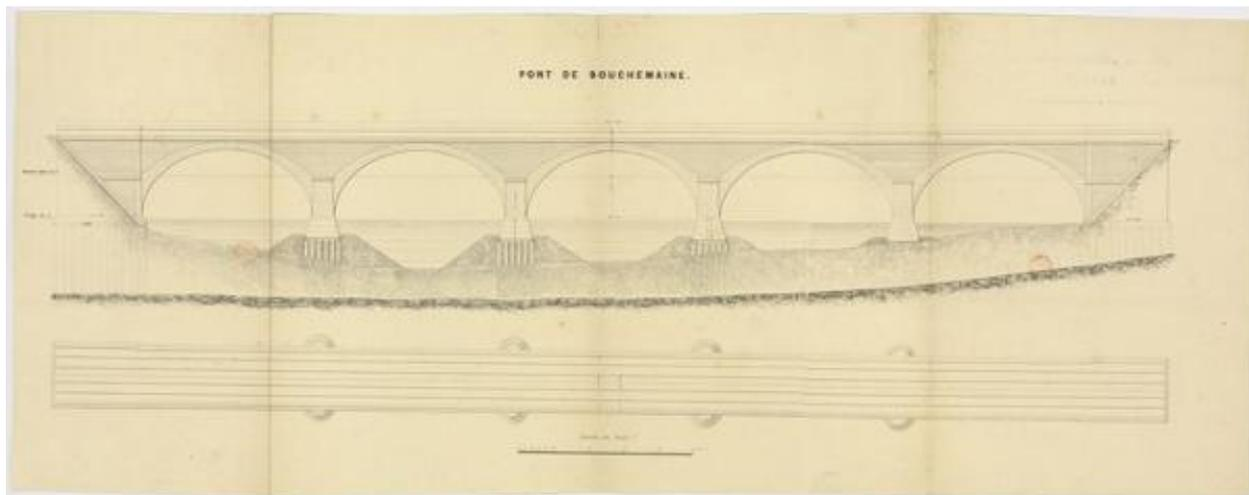
Plan du pont de Bouchemaine. Élévation d'ensemble - fondations des piles - et plan au niveau de la chaussée. Échelle 1/200 - Encre et papier.
