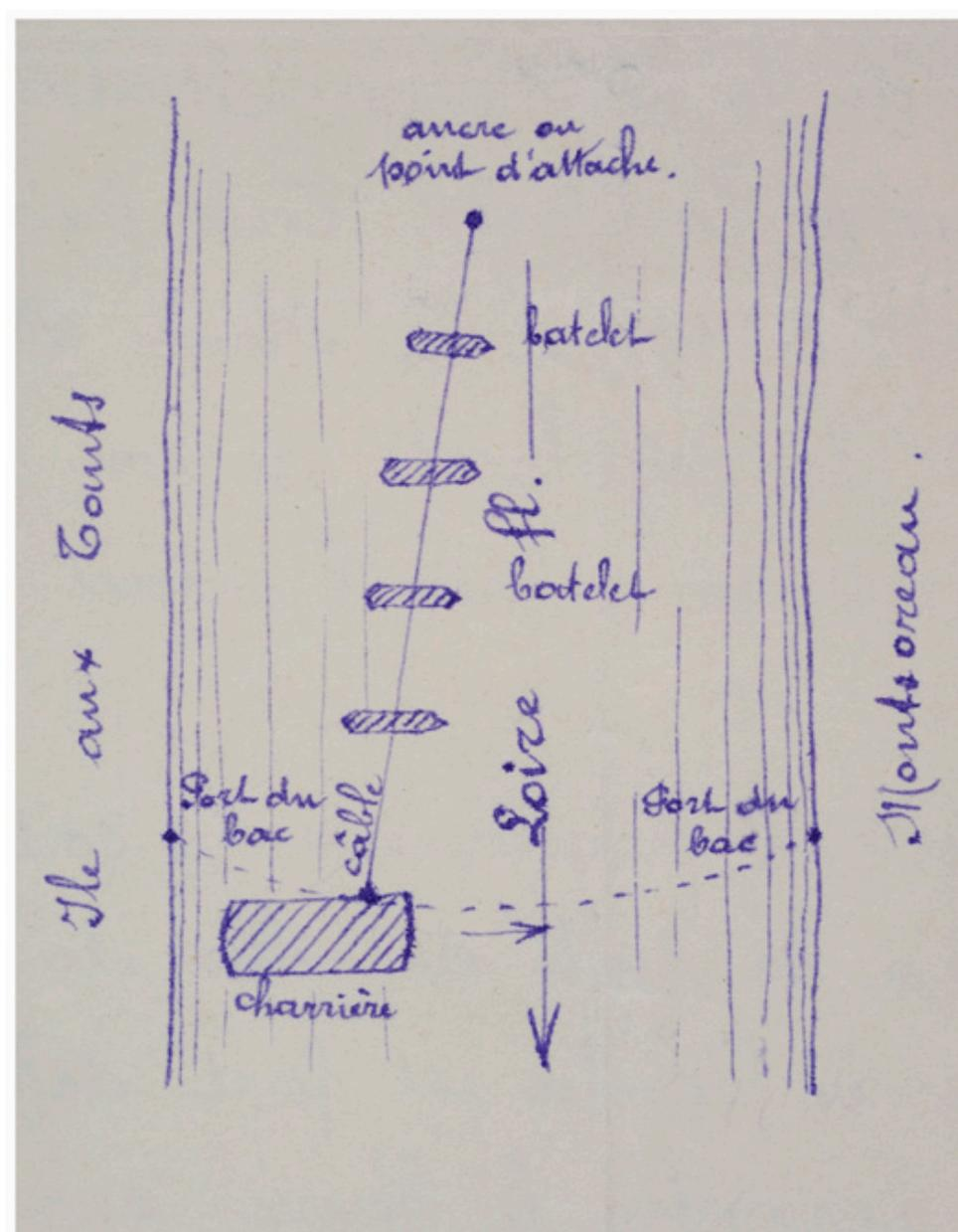
Projet Tranchant (non exécuté) d'un bac pendulaire à Montsoreau (1903) pour équiper le Port du passeur.
